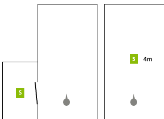
Figura 2. Configurazione per parlante dalla stanza adiacente (sinistra) e parlante distante (destra). Il quadrato verde con la "S" rappresenta l'oratore/parlante.
